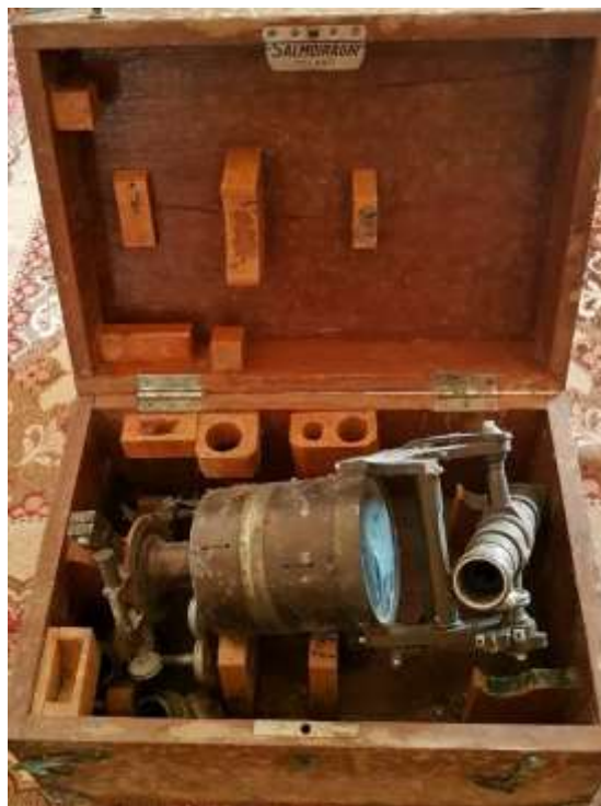
Livella da cantiere tra le più antiche usata da papà per individuare i dislivelli delle strade.
